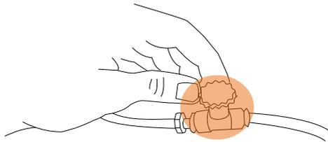
A partir de este momento, puede utilizar la válvula de control para poner en marcha/parar el aparato. Asegúrese de abrirla muy lentamente, la válvula de control es muy sensible.
