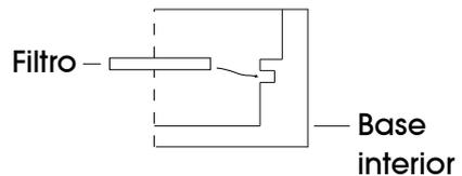
2- Montaje del tubo en la base
