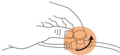
La válvula de control se utiliza para poner en marcha y detener el helio cuando utilizar el aparato. Cuando la manivela está paralela al tubo el aire fluirá, cuando esté a 90° grados del tubo se detendrá. Ponga la manija en posición paralela para ajustar la intensidad en el primer uso.
