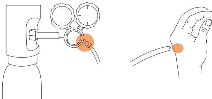
Coloque el extremo del tubo contra su piel y comience a girar la válvula reguladora en el sentido de las agujas del reloj muy lentamente hasta que sienta que sale aire. Esto te permitirá ajustar la intensidad con la que fluye el helio (su presión).
