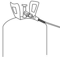
A continuación, regule la presión con el grifo en la parte central del tubo de conexión antes del tubo transparente.
