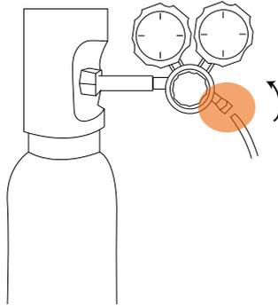
Conecte el tubo a la toma, presione firmemente para asegurarse de que está bien conectado y de que el helio no se escapa.
