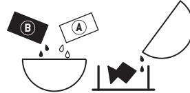
Los componentes empiezan a reaccionar inmediatamente al momento de la mezcla. Asegurarse de tener la caja de moldeo acabada y lista antes de mezclar.
